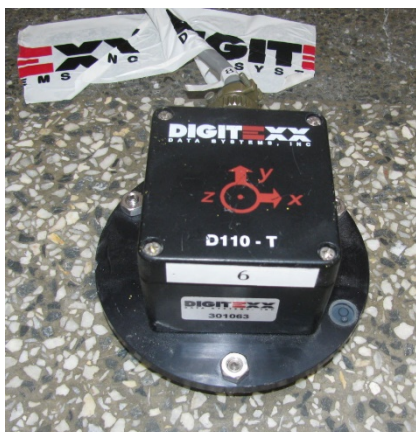
Fig. 2-2 Digitexx D110-T tri-axial sensor.
